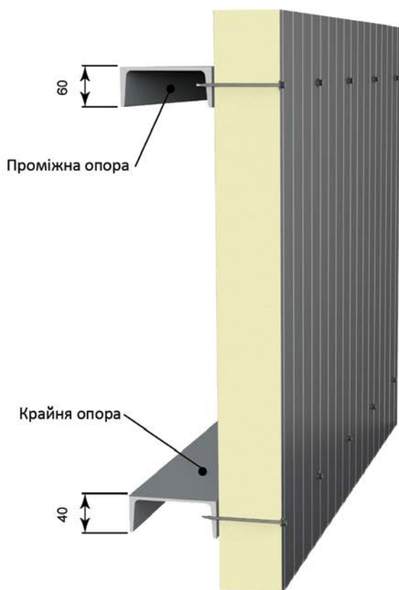
Мінімальні розміри ширини опор для кріплення стінових сендвіч-панелей
